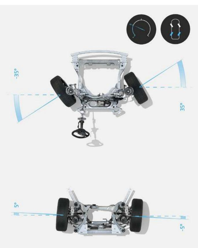
jusqu'à 50 km/h, les roues arrière tournent dans le sens opposé des roues avant pour réduire le diamètre de braquage
