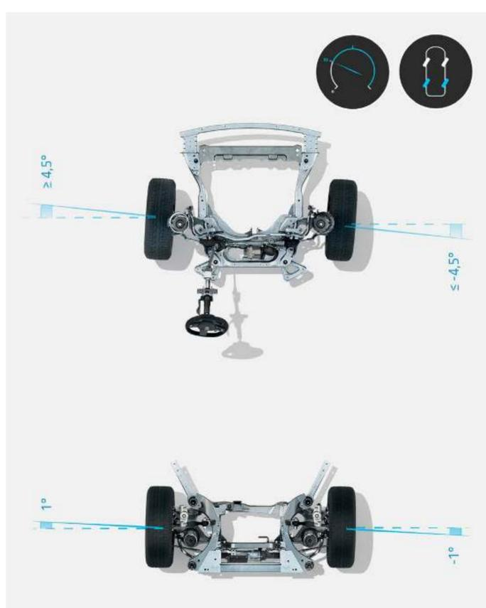
au-dessus de 50 km/h, les roues arrière tournent dans la même direction que les roues avant pour renforcer la tenue de route et améliorer la sécurité
