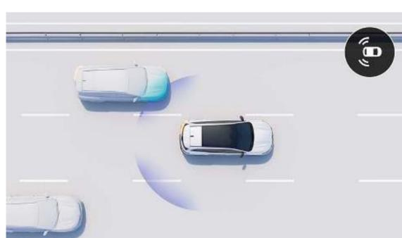
**avertisseur d'angle mort et de prévention en cas de dépassement** Le véhicule vous avertit d'une collision potentielle avec un véhicule qui dépasse dans la voie adjacente du véhicule lors des manœuvres de changement de voie. Si une collision est probable, il effectue une correction automatique d'urgence de la trajectoire.
