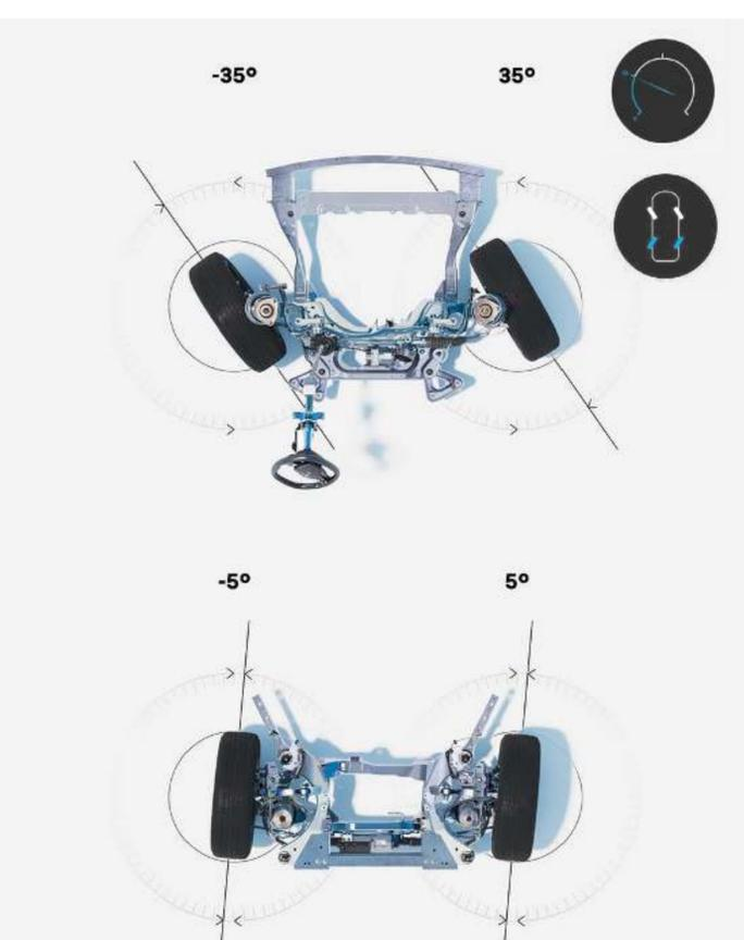
jusqu'à 50 km/h, les roues arrière tournent dans le sens opposé des roues avant pour réduire le diamètre de braquage et faciliter les manœuvres
