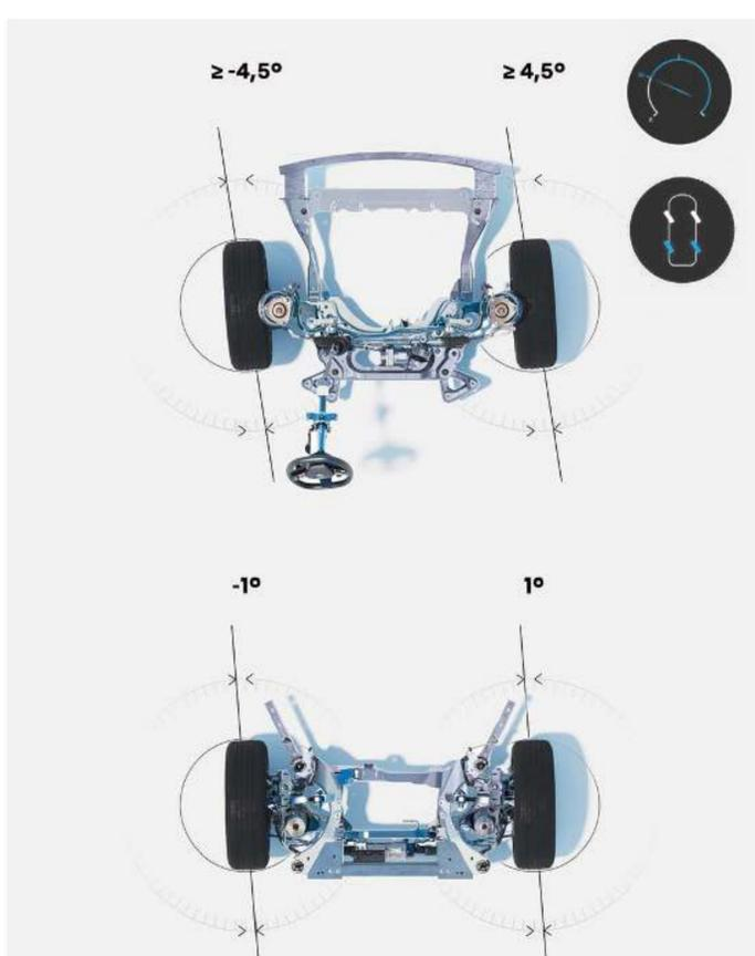
au-dessus de 50 km/h, les roues arrière tournent dans le même sens que les roues avant pour renforcer la tenue de route et améliorer la sécurité
