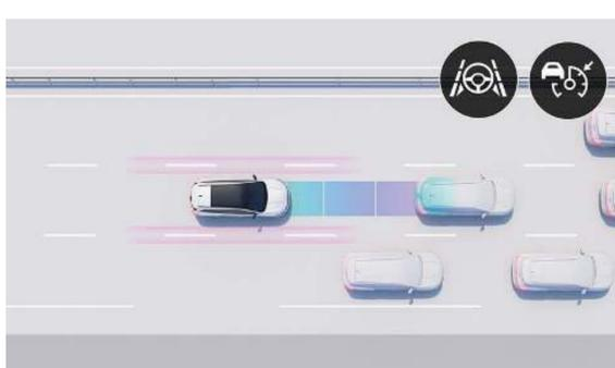
**active driver assist** Il régule la vitesse en tenant compte du contexte routier, maintient les distances de sécurité et assure le centrage dans la voie. Lorsque la circulation ralentit, le véhicule s'arrête et redémarre automatiquement.
