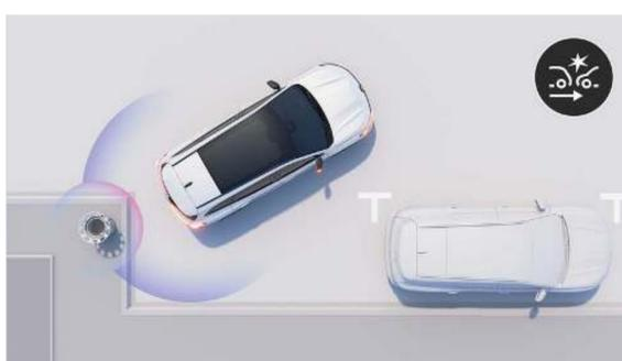
**freinage d'urgence automatique en marche arrière** Il détecte les obstacles à l'arrière et stoppe le véhicule automatiquement en cas de danger.
